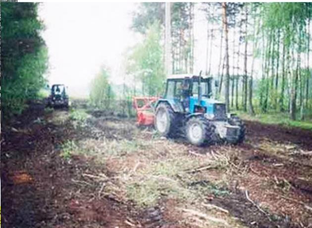
Применение навесного оборудования для утилизации порубочных остатков механизированным способом позволяет исключить такие операции как уборка, вывоз и сжигание порубочных остатков на территории охранных зон линий электропередач, нефтегазопроводов.
